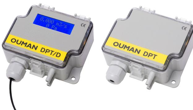
DPT paine-erolähettimet soveltuват ilman ja neutraalien kaasujen pienien ylipaineiden, alipaineiden ja paine-erojen mittaukseen. Lähettimestä saadaan sekä virta- että jänniteulos-tuloviestit. Lähettimien käyttökohteina voivat olla esim. suodatinvalvonta ja puuhalmien painesäädöt. Paine-erolähettimiä on saatavana sekä näytöllisenä (DPT/D) että ilman näyttöä (DPT). Mitta-alueeksi on valittavissa mittausalue 8:sta eri vaihtoehdosta (ks. alla).
